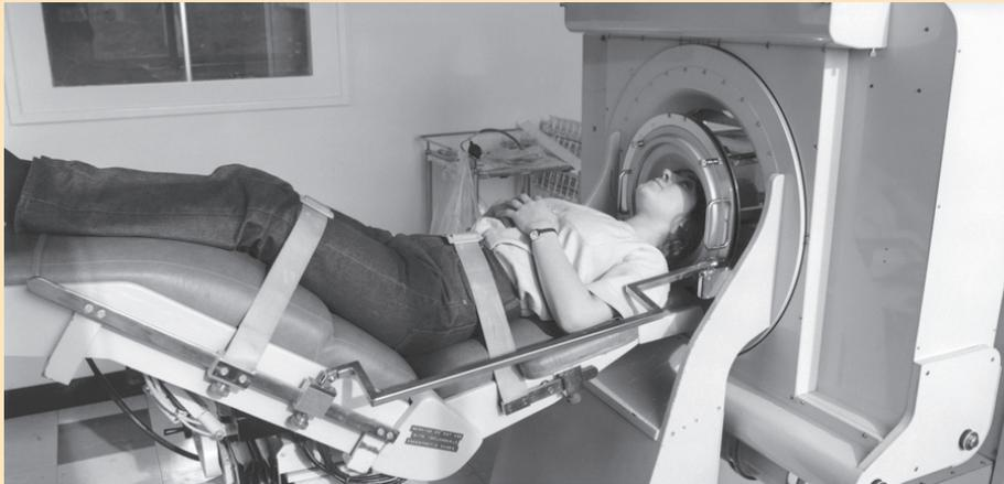
Figura 6. Prototipo de escáner desarrollado por Hounsfield.
